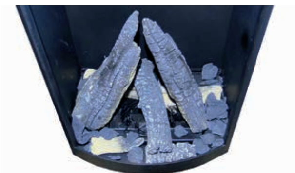
Répartissez les morceaux d'écorce (08) sur le fond. Veillez à ce que le brûleur MAIN ne soit pas couvert.
